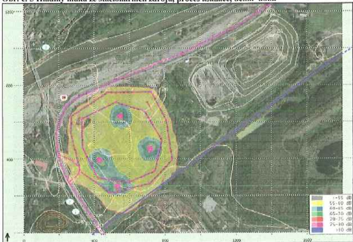
Obr. č. 5 Hladiny hluku ze stacionárních zdrojů, proces asanace, denní doba
